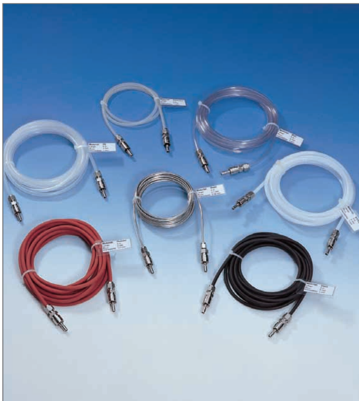
In einem Modellversuch prüfte die Westfalen AG die Durchlässigkeit verschiedener Leitungsmaterialien. Am besten schnitt Edelstahl (Mitte) ab.
