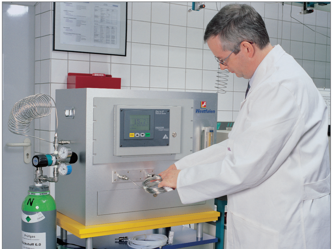
Der Versuchsaufbau: Hochreiner Stickstoff wird durch unterschiedliche Schlauchmaterialien geleitet. Der dabei jeweils gemessene Sauerstoffgehalt ist höchst unterschiedlich.
