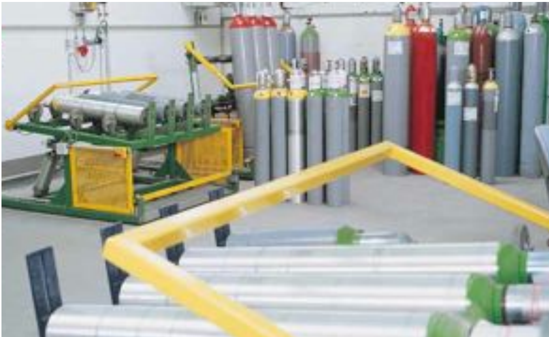
Rollenmischstationen zur Homogenisierung gravimetrisch hergestellter Gasgemische.
